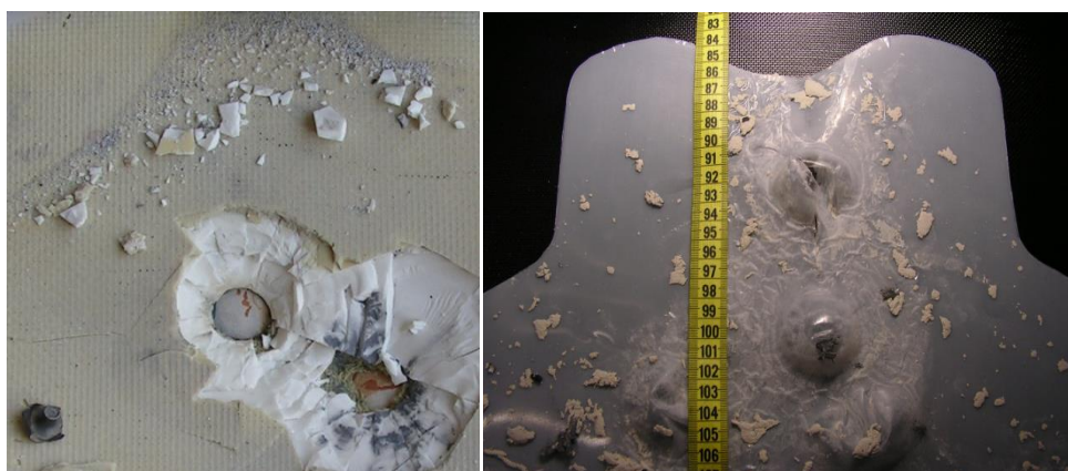
Ballisztikai kerámiában a 7,62 x 39 (43M) PSZ töltény lövedékek által létrehozott kráterek, szilánkok és a törmelék a kimeneti nyílások felől. Háttéranyagból (plasztilinből) kiszakadt anyag darabok – Frank György felvételei-
