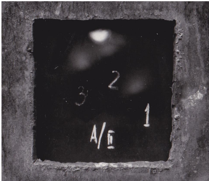
Lövedékek becsapódásainak hatására a mintán létrejött alakváltozások átszakadás, áthatolás nélkül (FGY felvétel)
