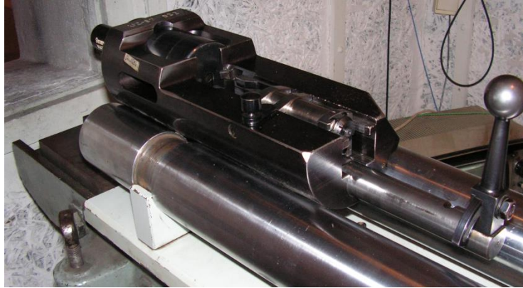
Jaspar állványon rögzített ballisztikai mérőcső, mérési helyzetben (FGy felvétel)
