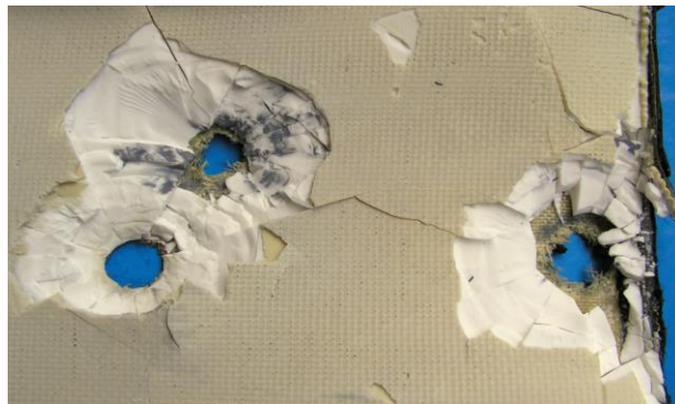
A becsapódott lövedékek hatásaira szilánkok szakadtak ki a ballisztikai kerámia test felöli oldalán (FGY felvétele)
