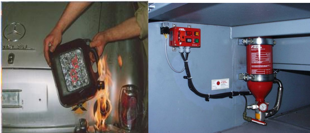
1. ábra. Elfojtó töltettel ellátott üzemanyag kanna nem gyullad be. Tűzoltó készülék rácsatlakozással, védett járműben
