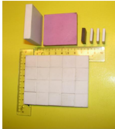
90 – 97,5 % \text{Al}_2\text{O}_3 tartalmúnak meghatározott A-BAL jelű ballisztikai kerámia minta lapok
