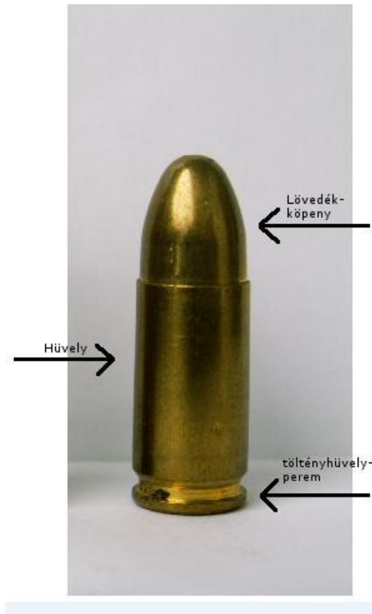
1. kép 9 mm Parabellum töltény felépítése (forrás alapján saját munka, kép forrása: http://hu.wikipedia.org/wiki/F%C3%A1jl:Tokarev.parabellum,32.JPG , letöltés ideje: 2013. október 05.)
