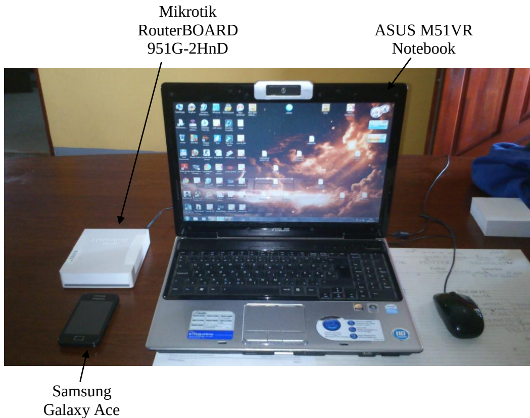
15. kép: Aktív lokáció időméréssel mérési elrendezése Forrás: Saját szerkesztés
