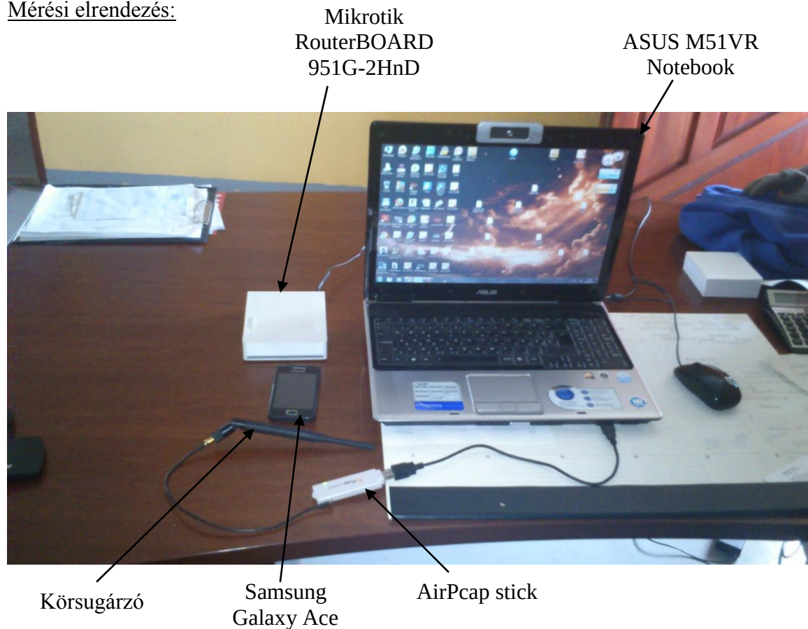
22. kép: Passzív lokáció jelintenzitás méréssel, körsugárzóval Forrás: Saját szerkesztés
